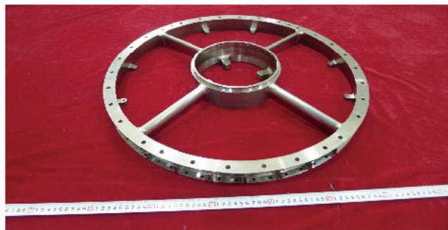
航天某型号用的 Ti_2AlNb 粉末支板
