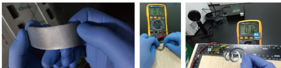
利用“人体体温”测试BiTe基柔性热电薄膜发电性能（内阻1.9Ω，开路电压1.2mV）
