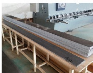
龙舟-CNSC乏燃料运输容器用碳化硼铝中子吸收板及容器原型样机
