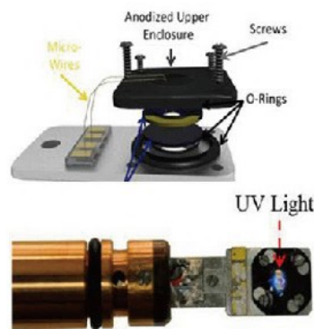
透射电镜原位光催化样品杆 (JEOL型)
