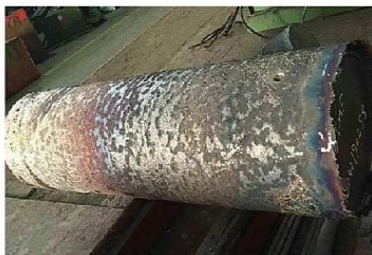
图4、5吨级SIMP钢铸锭（真空感应+真空自耗）
