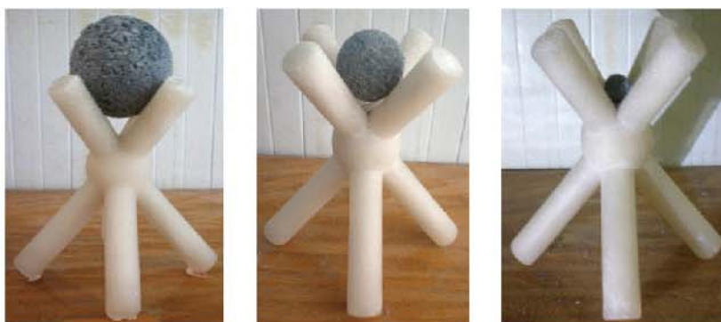
图1 可溶压裂球（直径60 mm）在90℃水中于12小时内的溶解测试
