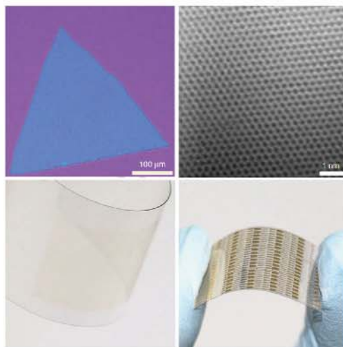
大面积高质量均一单层 \text{WS}_2 单晶、薄膜及柔性透明薄膜晶体管阵列
